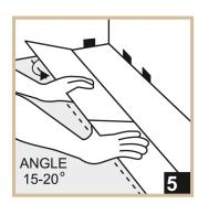
Gleichen Sie die Kopfenden der Dielen an und stecken Sie die Feder der Längsseite in einem Winkel von ungefähr 15-20° in die Nut der vorherigen Beibe
