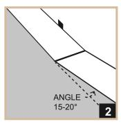
Stecken Sie das Kopfende der nächsten Diele in einem Winkel von ca. 15-20° in die Nut der ersten und drücken Sie diese nach unten.
