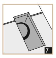
Für Heizungs- oder Entlüftungsschächte sollten Sie eine Aussparung im Boden zuschneiden.
