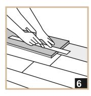
Passen Sie bei der letzten Reihe des Bodens die Dielen an den Abstand zur Wand an, in dem Sie eine Diele wie eine Schablone auf die zuletzt verlegte Reihe legen und mit einer weiteren Diele den Wandverlauf darauf markieren. (Achten Sie dabei auf die Dehnungsspalte.)
